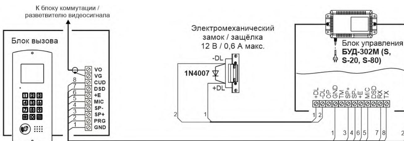
Рисунок 8.7 – Схема соединений блока вызова с блоком управления БУД-302М (S, S-20, S-80), электромагнитным замком VIZIT-ML400 и кнопкой EXIT 300М
