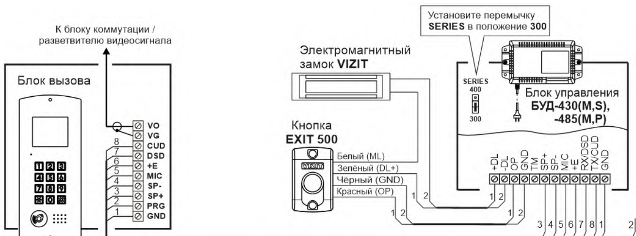
Рисунок 8.1 – Схема соединений блока вызова с блоком управления БУД-430(М,С), -480(С), -485(М,Р), электромагнитным замком VIZIT-ML400 и кнопкой EXIT 1000
