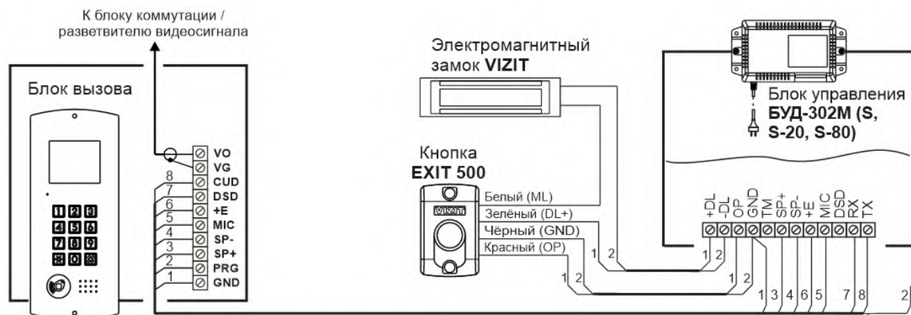
Рисунок 8.5 – Схема соединений блока вызова с блоком управления БУД-302M (S, S-20, S-80), электромагнитным замком VIZIT-ML400 и кнопкой EXIT 1000
