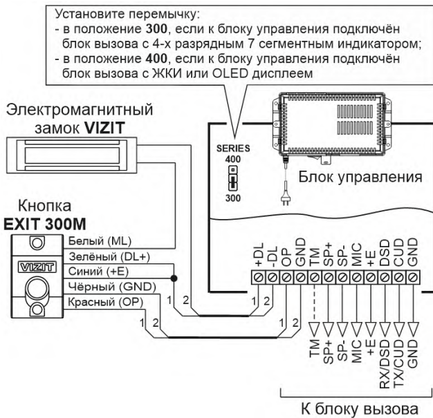
Рисунок 11.3 – Схема соединений блока управления, блока вызова, электромагнитного замка и кнопки EXIT 300M
