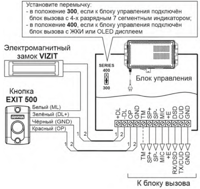
Рисунок 11.2 – Схема соединений блока управления, блока вызова, электромагнитного замка и кнопки EXIT 500
