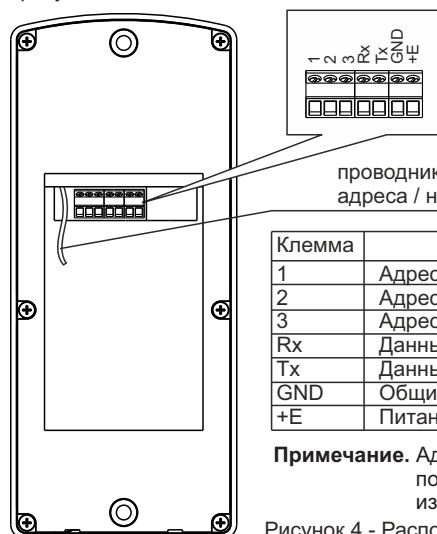
Рисунок 4 - Расположение и назначение клемм кнопочной панели
