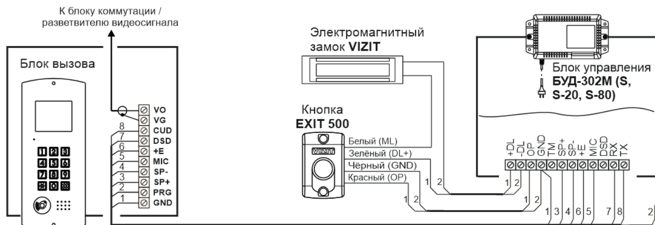
Рисунок 8.5 – Схема соединений блока вызова с блоком управления БУД-302М (S, S-20, S-80), электромагнитным замком VIZIT-ML400 и кнопкой EXIT 1000
