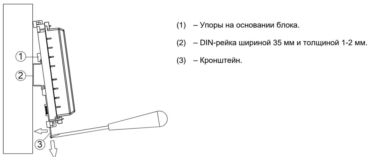
**Рисунок 7.1 – Крепление блока управления на DIN-рейку**
