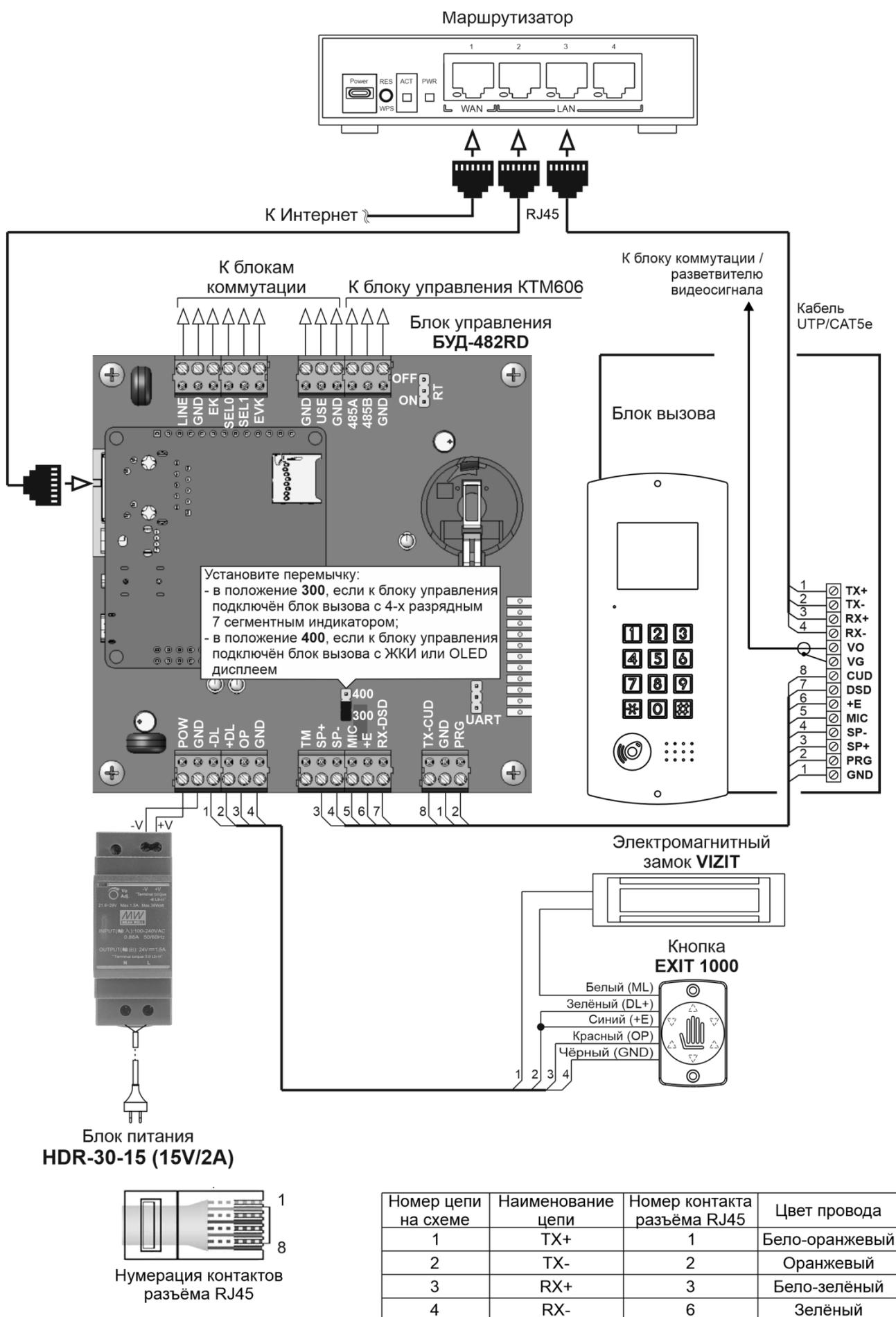
Рисунок 9.1 – Схема соединений блока управления, блока вызова, блока питания, электромагнитного замка и кнопки EXIT 1000
