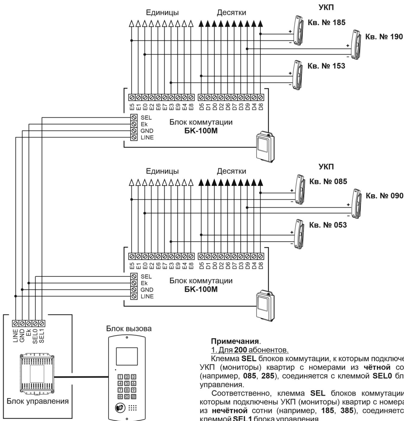
Рисунок 9.5 – Схема соединений управления с блоками коммутации БК-100М
