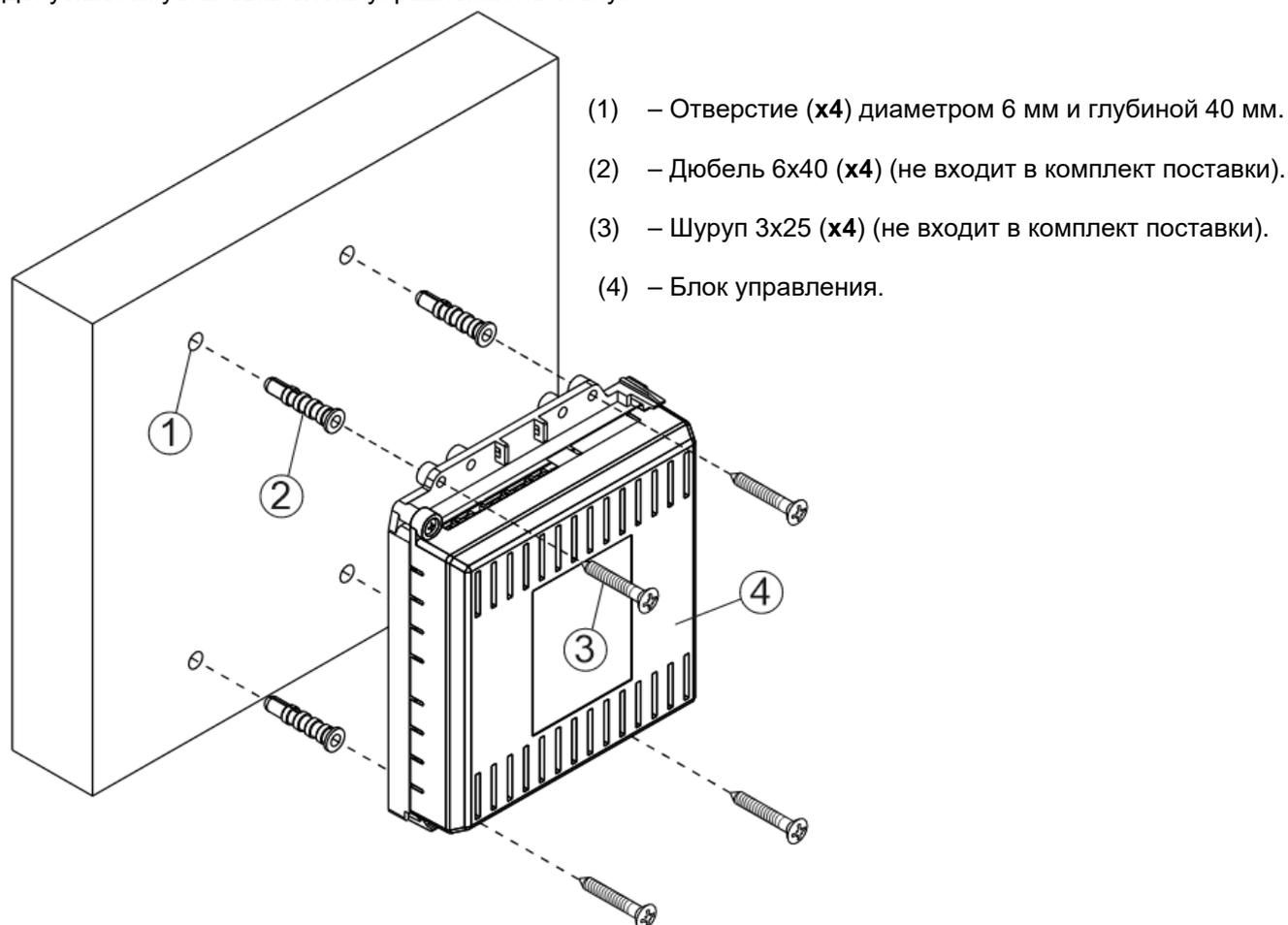
**Рисунок 7.2 - Крепление блока управления на стену**
