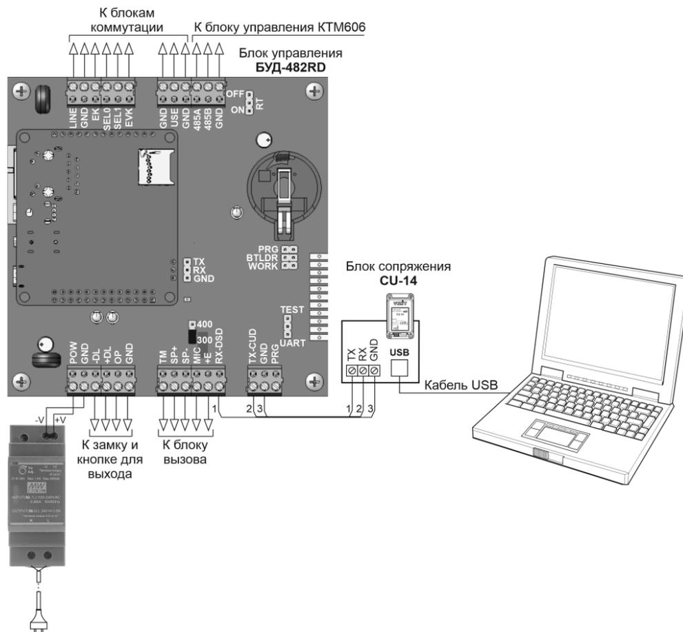
Рисунок 12.1 - Схема соединений блока управления с блоком сопряжения CU-14
