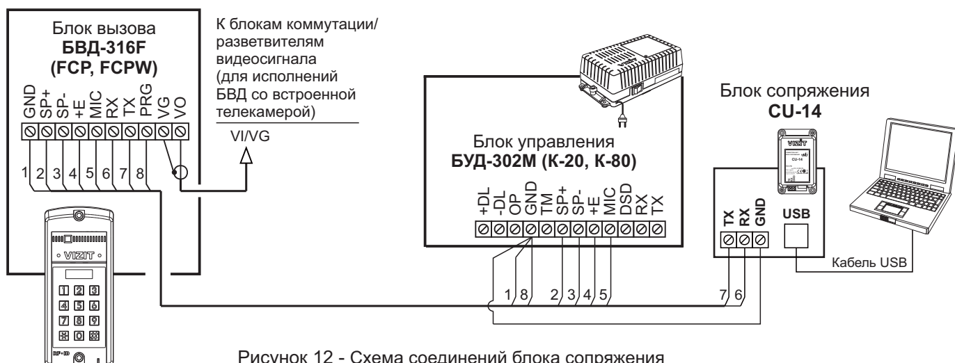
Рисунок 12 - Схема соединений блока сопряжения с блоками управления БУД-302М (К-20, К-80)
