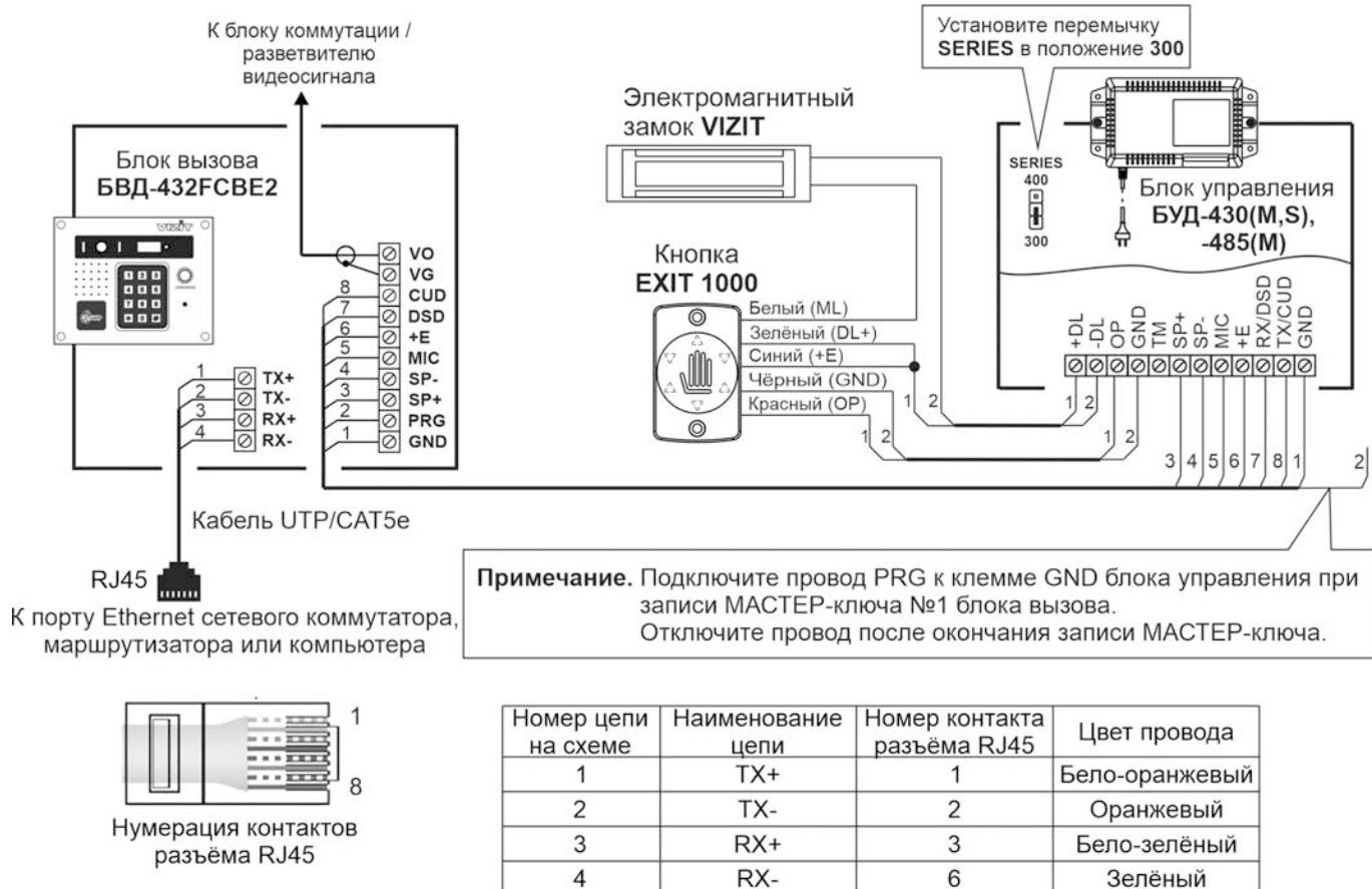
**Рисунок 8.1 – Схема соединений блока вызова БВД-432FCBE2 с блоком управления БУД-430(M,S), -485(M), электромагнитным замком VIZIT-ML400 и кнопкой EXIT 1000**
