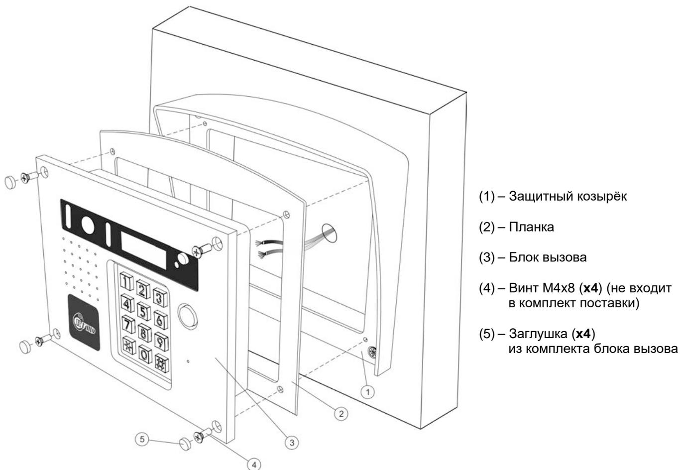
Рисунок 6.3 - Установка блока вызова на монтажный комплект МК-432
