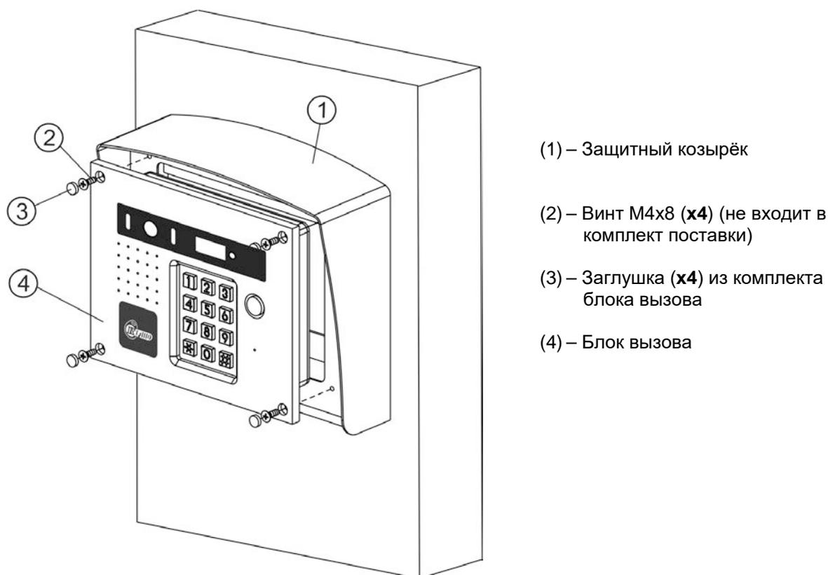
Рисунок 6.4 - Установка блока на монтажный комплект МКФ-432
