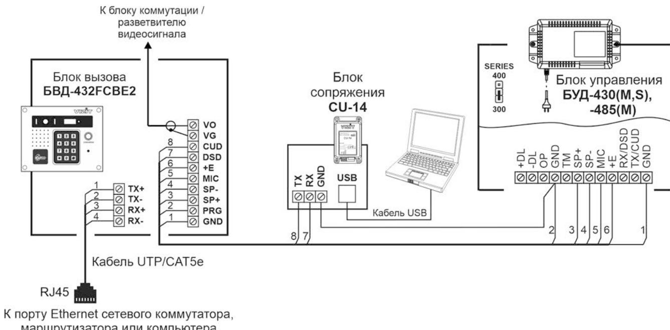
**Рисунок 16.1 - Схема соединений блока вызова с блоками управления БУД-430(С, М), -485(М) и блоком сопряжения СУ-14**
