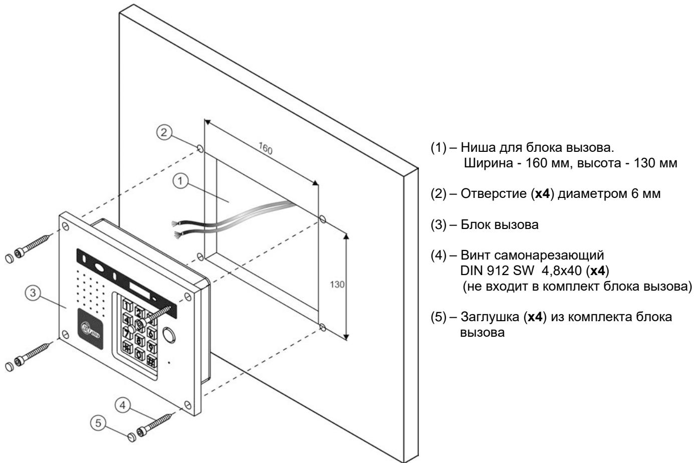
Рисунок 6.2 – Установка блока вызова на наподвижной части металлической двери
