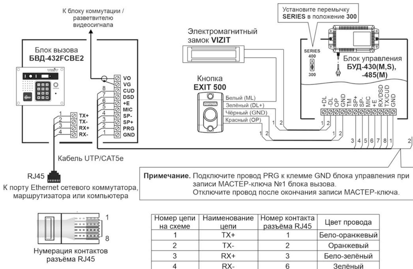
**Рисунок 8.2 – Схема соединений блока вызова БВД-432FCBE2 с блоком управления БУД-430(M,S), -485(M,MP), электромагнитным замком VIZIT-ML400 и кнопкой EXIT 500**
