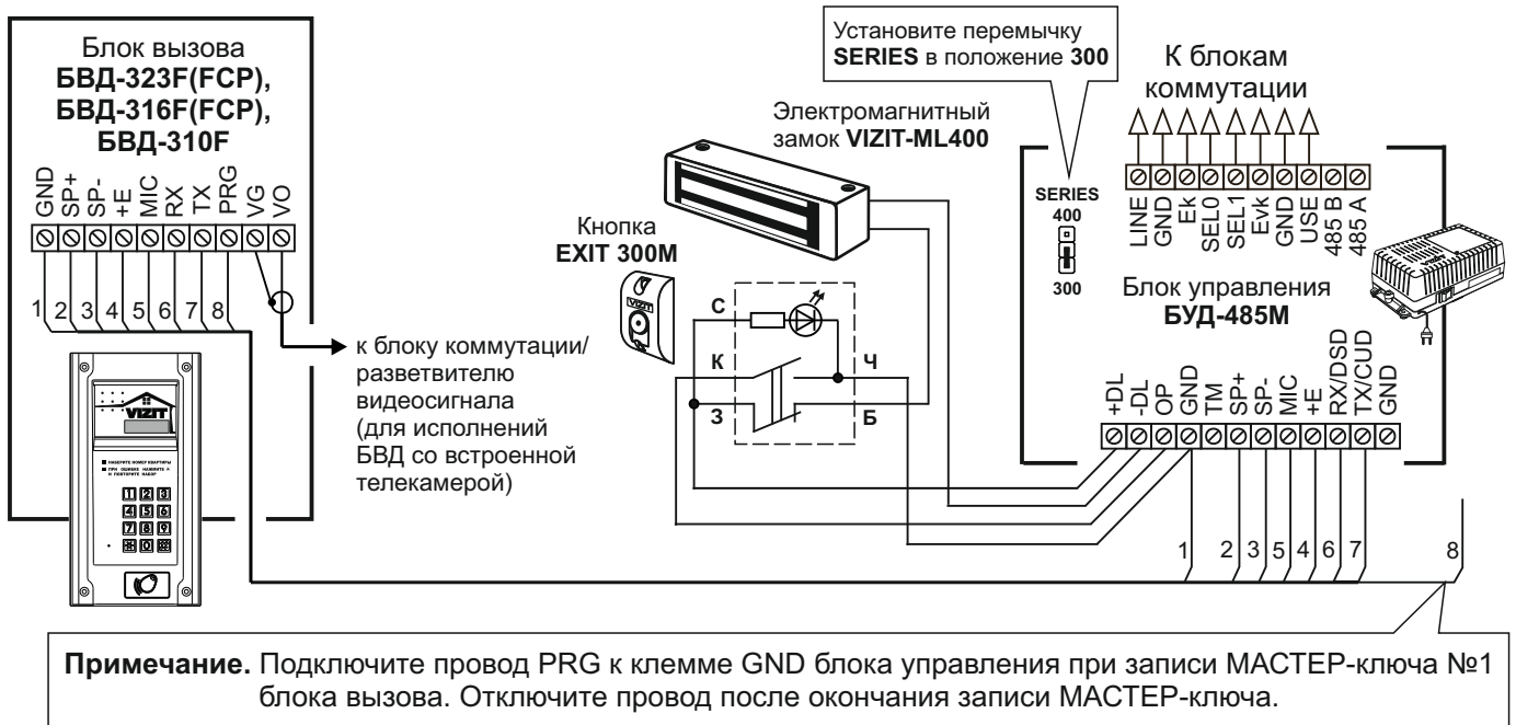
Рисунок 1 - Схема соединений блока вызова БВД-323F(FCP), БВД-316F(FCP), БВД-310F с блоком управления БУД-485М , электромагнитным замком VIZIT-ML400 и кнопкой EXIT 300M
