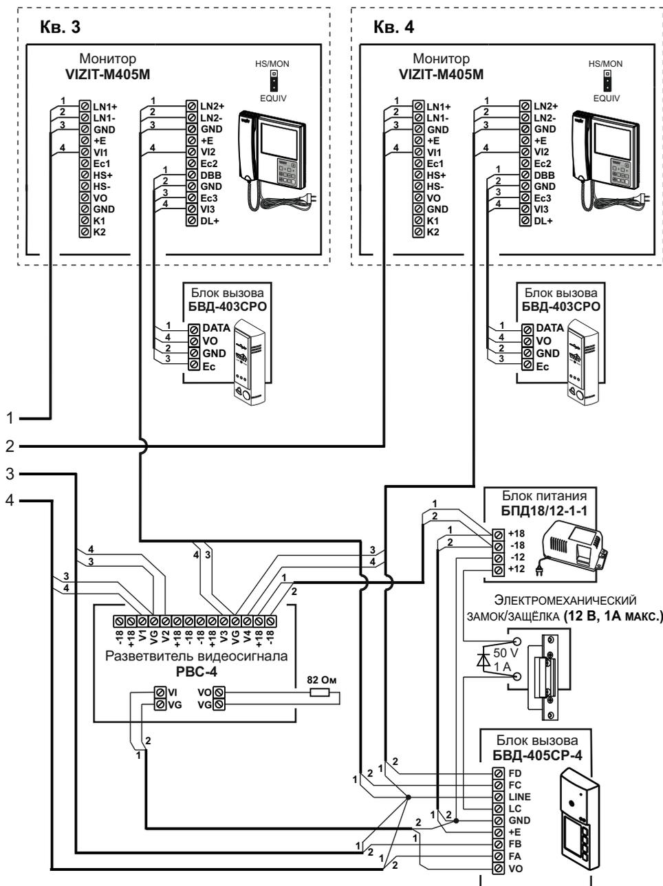
Рисунок 10 - Схема соединений мониторов VIZIT-M405M с блоком коммутации БК-4AV и блоком вызова БВД-405СР-4
