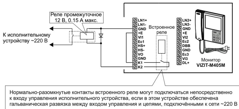
Рисунок 5 - Схема соединений промежуточного реле с питанием обмотки от встроенного в монитор источника питания. Встроенное реле включается на время нажатия кнопки монитора.
