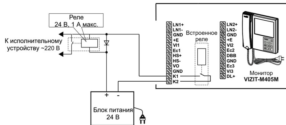
Рисунок 6 - Схема соединений промежуточного реле с питанием обмотки от внешнего блока питания. Встроенное реле включается на время нажатия кнопки монитора.
