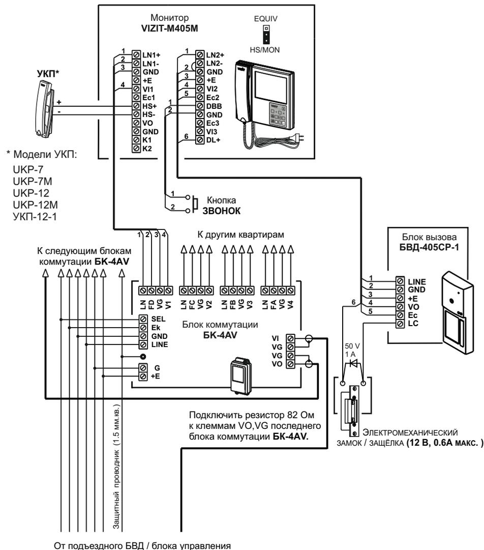
Рисунок 7 - Схема соединений монитора VIZIT-M405M с блоком коммутации БК-4AV, малоабонентским блоком вызова, дополнительным УКП и кнопкой ЗВОНОК
