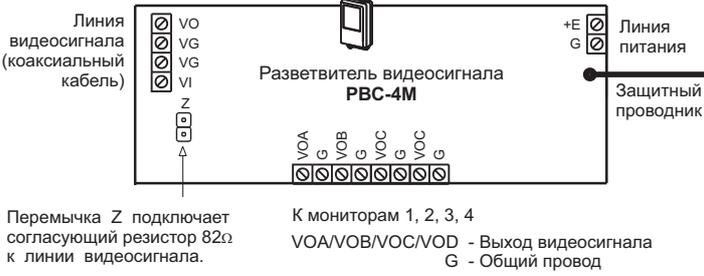
Рисунок 1 - Расположение клемм, назначение цепей и перемычек
