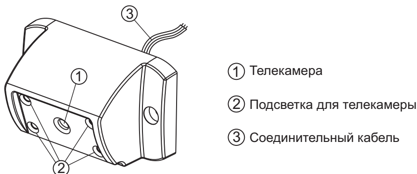
Рисунок 1 - Внешний вид телекамеры
