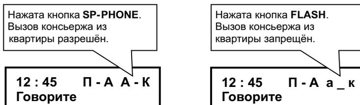
Для сохранения изменений нажать кнопку **STORE**. Блок управления переходит в дежурный режим. Разрешить связь "Абонент - Консьерж" для данной квартиры можно только в режиме **сервисных установок**.
