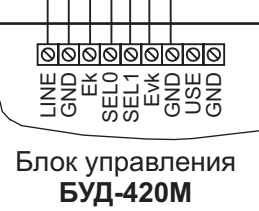
Рисунок 8 - Схема соединений блока управления БУД-420М с монитором VIZIT-M430C и блоком коммутации БК-4V(MV) в составе 200 квартирного видеодомофона
