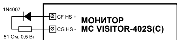
Рисунок 6 - Схема подключения эквивалента нагрузки вместо параллельно подключаемых УКП или монитора
