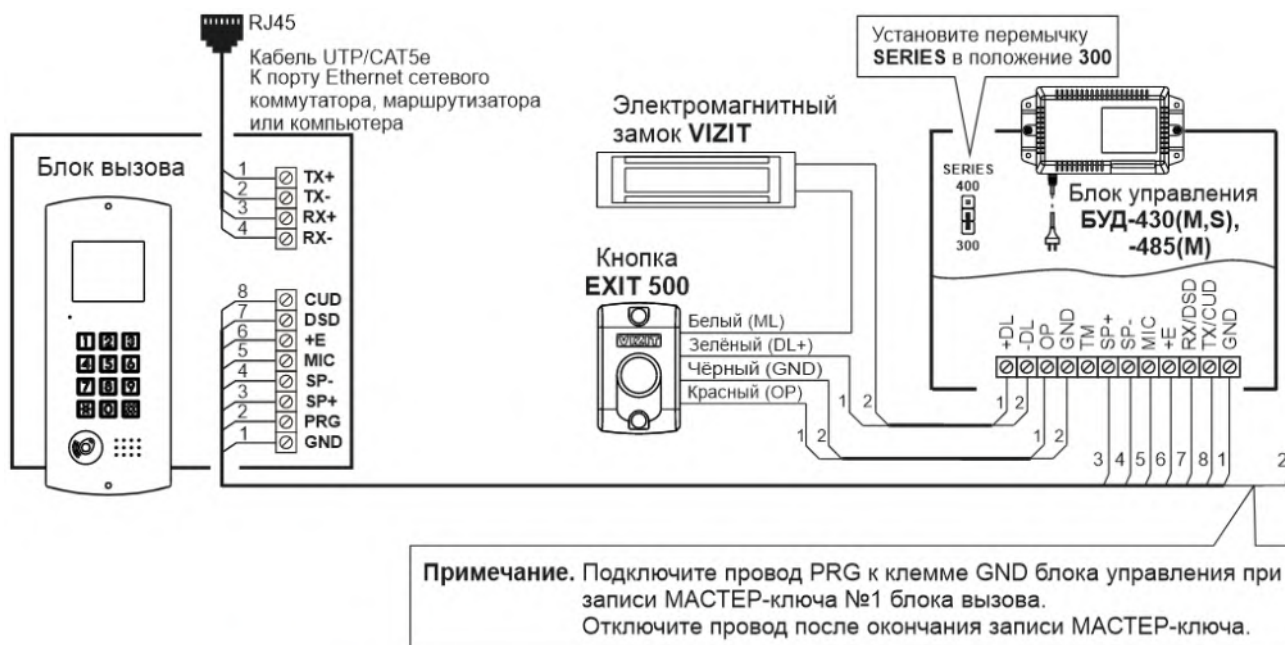
Рисунок 8.1 – Схема соединений блока вызова с блоком управления БУД-430(M,S), -480(S), -485(M,P), электромагнитным замком VIZIT-ML400 и кнопкой EXIT 1000
