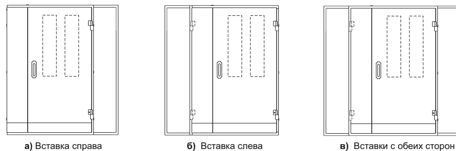
Рисунок 3 - Примеры использования боковых вставок при ширине проёма от 1600 до 2500 мм.
