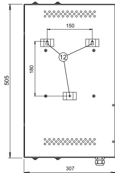
Рис.1 - Внешний вид, габаритные и установочные размеры бокса
