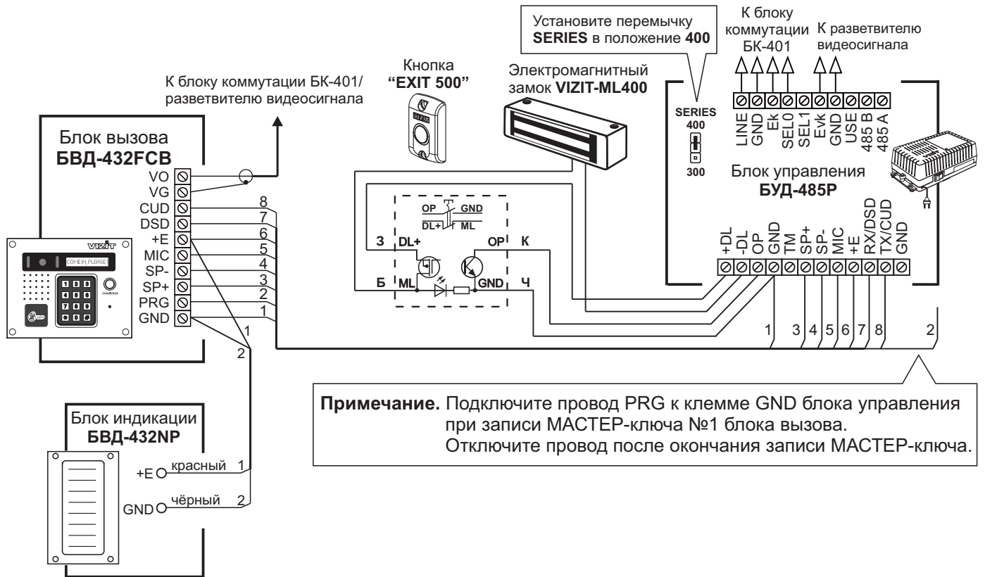
Рисунок 3 - Схема соединений блока вызова БВД-432ФСВ с блоком управления БУД-485Р, блоком индикации БВД-432НР, электромагнитным замком VIZIT-ML400 и кнопкой "EXIT 500"
