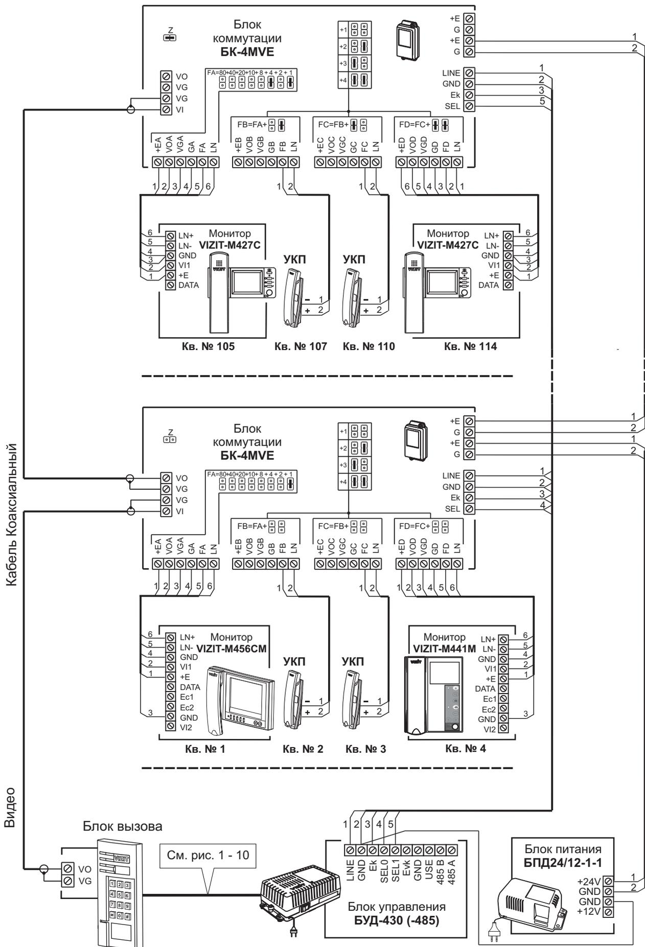
**Примечание.** Рекомендации по расчёту допустимого количества мониторов, подключаемых к одному блоку питания БПД24/12-1-1 приведены в инструкции по эксплуатации блока коммутации БК-4МВЕ.
