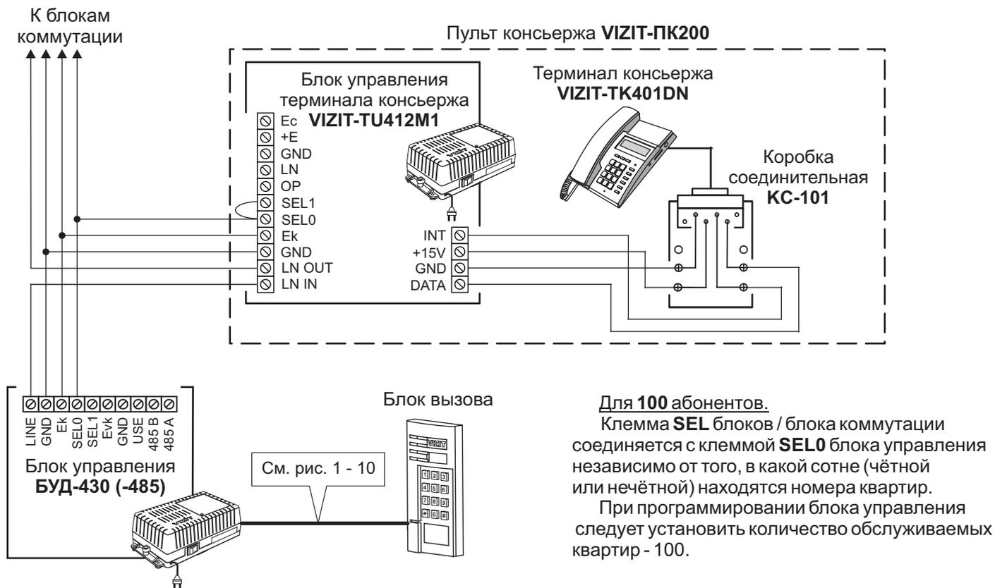
Рисунок 15 - Схема соединений блока управления **БУД-430 (-485)** с пультом консьержа **VIZIT-ПК200** в составе многоквартирного домофона до 100 абонентов
