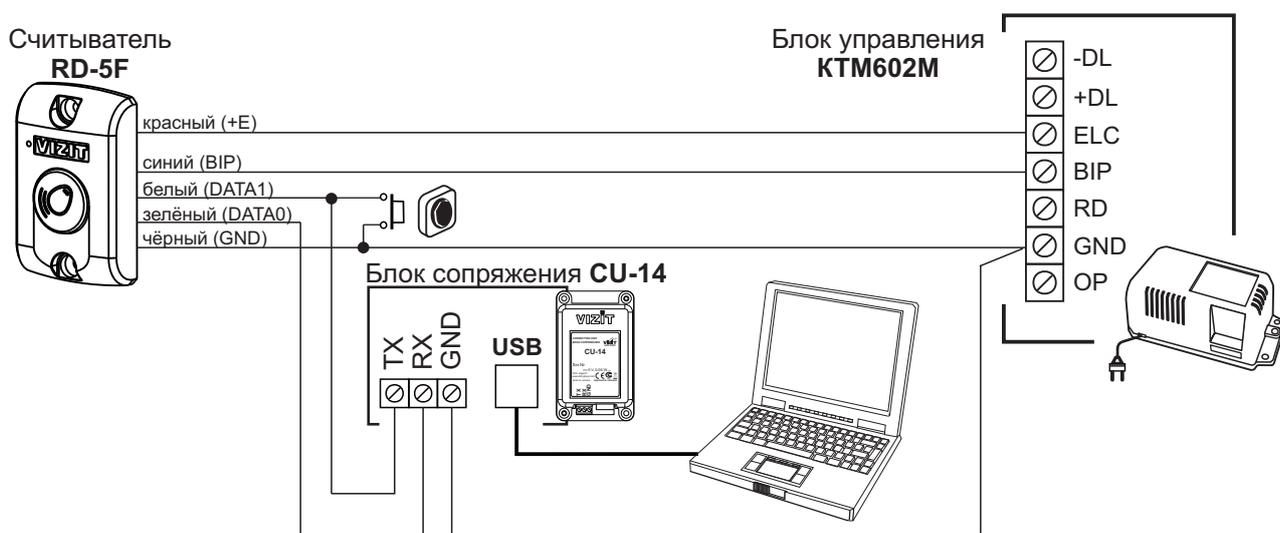
Схема соединений считывателя с блоком сопряжения CU-14 и компьютером
