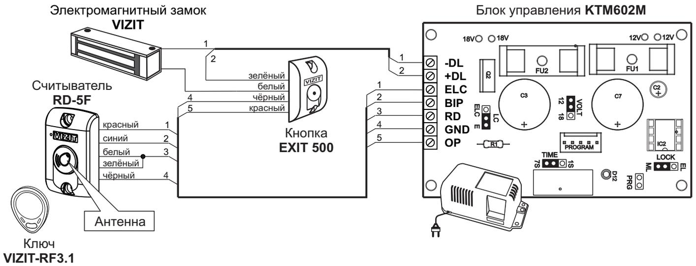
**Контроллер с электромагнитным замком и кнопкой EXIT 500**
