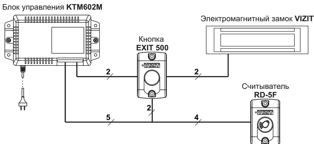
**Примечание.** Кнопки EXIT500 и EXIT 300M предназначены для разблокирования замка изнутри помещения.
