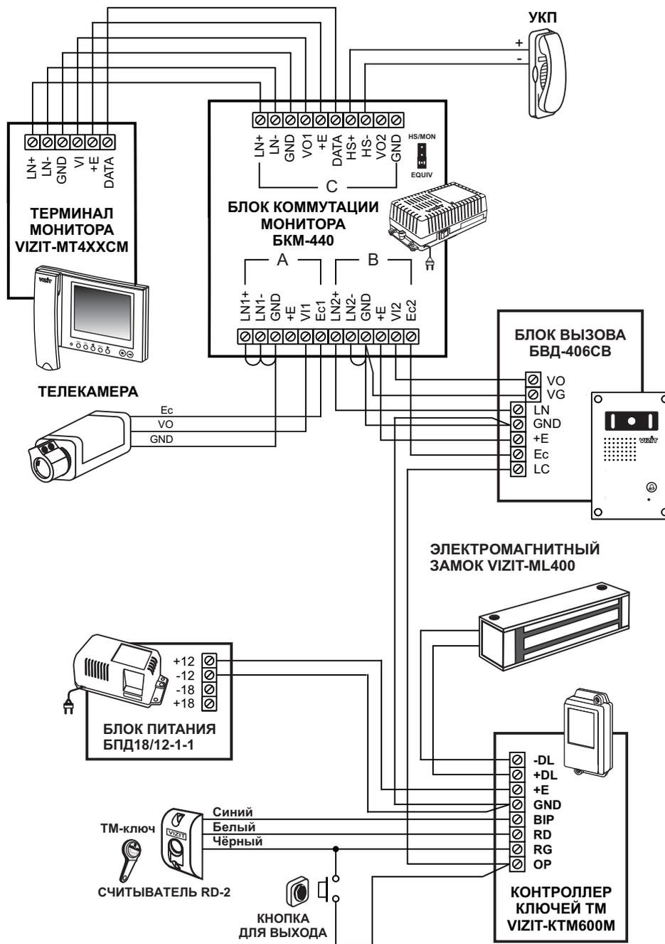
Рисунок 2 - Схема соединений блока коммутации монитора **БKM-440** с терминалом монитора **VIZIT-MT4XXCM**, блоком вызова **БВД-406СВ**, дополнительной телекамерой, контроллером ключей ТМ **VIZIT-KTM600M** и электромагнитным замком
