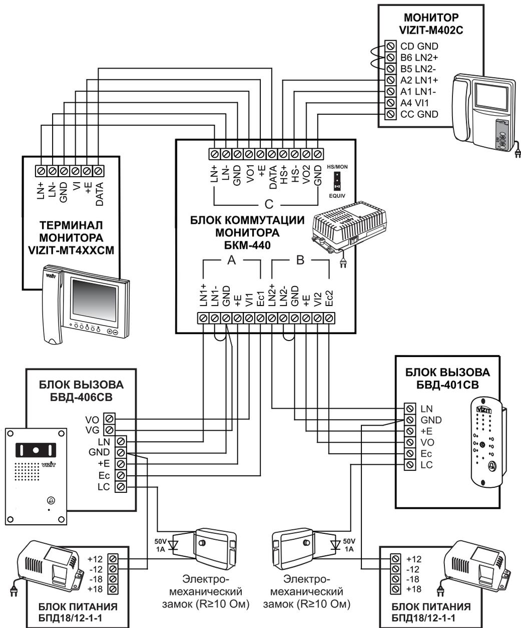
Рисунок 3 - Схема соединений блока коммутации монитора **БКМ-440** с терминалом монитора **VIZIT-MT4XXCM**, блоками вызова **БВД-406CB**, **БВД-401CB** и дополнительным монитором **VIZIT-M402C**
