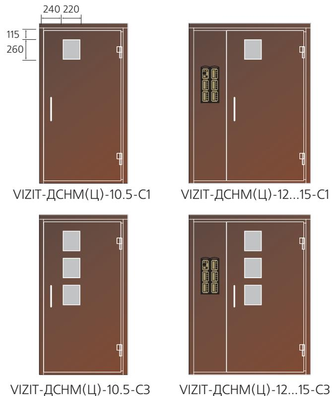
1. Дверные блоки VIZIT-ДСНМ(Ц)-10,5-Пр(Лв) производятся без вставки и не могут быть доработаны под установку блока вызова VIZIT.
