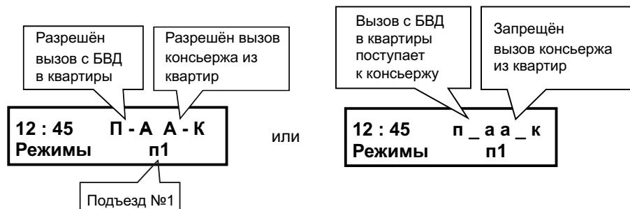
2. Для включения / выключения **переадресации вызова всех абонентов из определенного подъезда на консьержа** нажмите **AUTO**.
