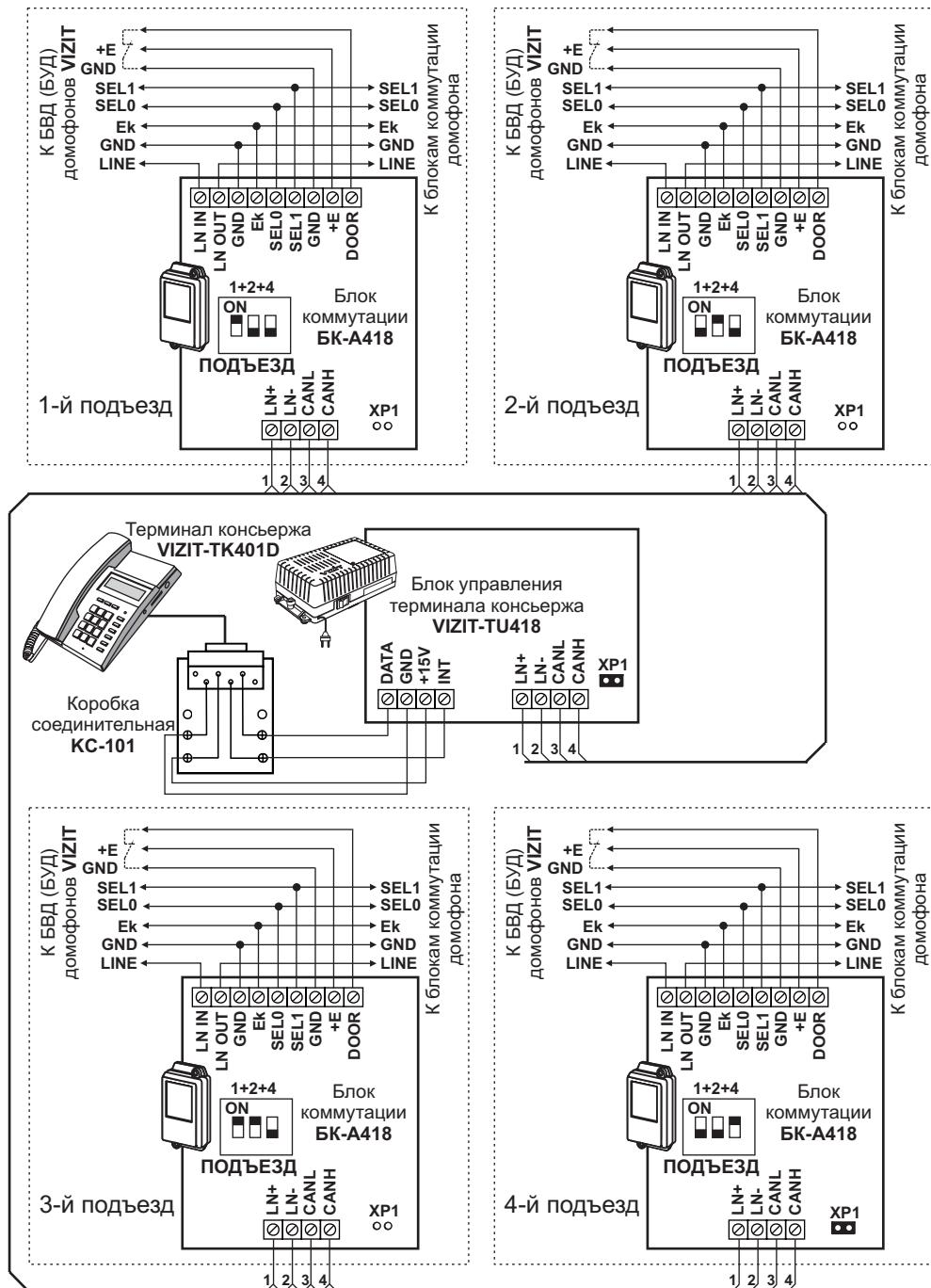
Рисунок 1 - Схема соединений блока управления с терминалом и **БК-А418**
